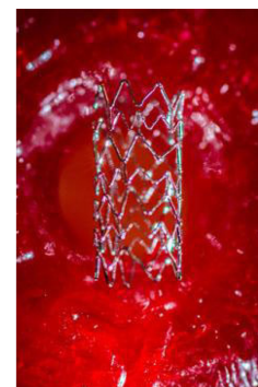
El stent de zinc es soluble y resiste la corrosión. Foto por Sarah Bird, Michigan Tech.
